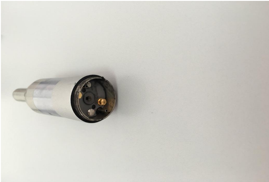
Figura 7.Micromotor cu 4 orificii, aspect orificii
